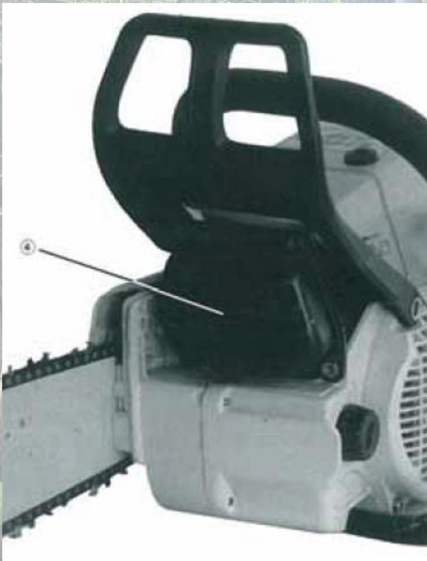
La marmitta riduce i rumori e insieme alle cuffie auricolari previene le lesioni dell'apparato uditivo. I gas nocivi emessi sono soprattutto idrocarburi incombusti e monossido di carbonio.
