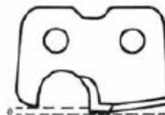
La forma del dente inclinata all'indietro fa sì che, dopo ogni affilatura, il tetto del dente si accorci leggermente riducendo quindi il dislivello (a) rispetto al limitatore di profondità; anche quest'ultimo, perciò, di tanto in tanto va accorciato con la lima piatta. In genere il costruttore fornisce istruzioni al riguardo; l'operazione è facilitata dall'impiego di apposite lime.
