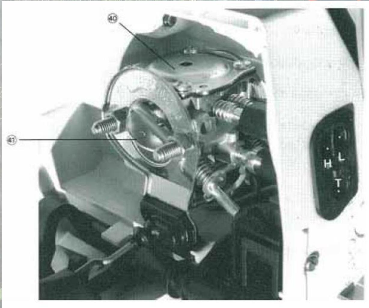
Sul carburatore vi sono due viti di regolazione che controllano il buon funzionamento del motore, in genere contraddistinte con le lettere "H" (dall'inglese high) e "L" (dall'inglese low).
