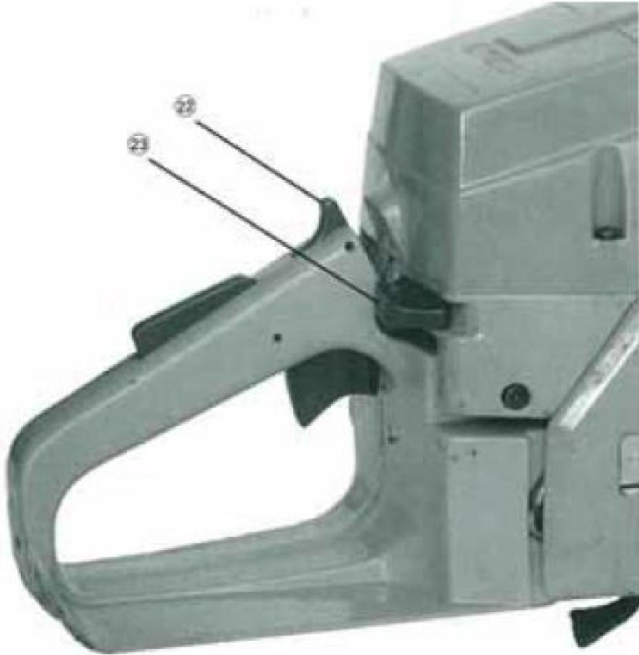
Al momento della messa in moto, questo comando permette di bloccare l'acceleratore a mezzo regime; in molti modelli tale funzione è svolta dallo starter. Quando si aziona l'acceleratore il bloccaggio si disinserisce automaticamente.
